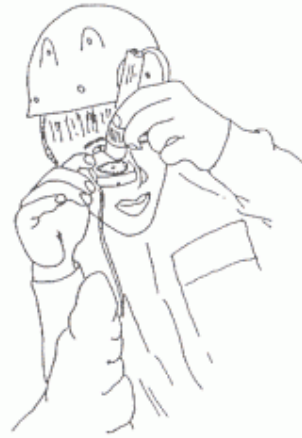
Reading a Suunto compass
