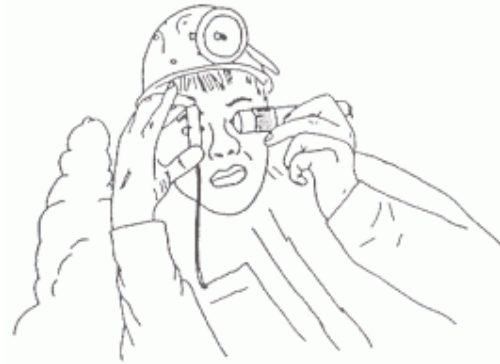
Reading a Suunto clinometer
