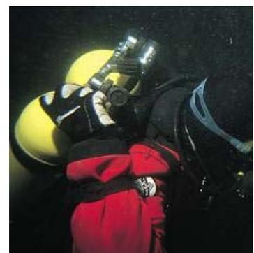
**Schritt 3:** Ventil der defekten Seite (mit der Leckage) ebenfalls bis an den Anschlag schliessen. Anschliessend zügig Wechsel des Lungenautomaten!
