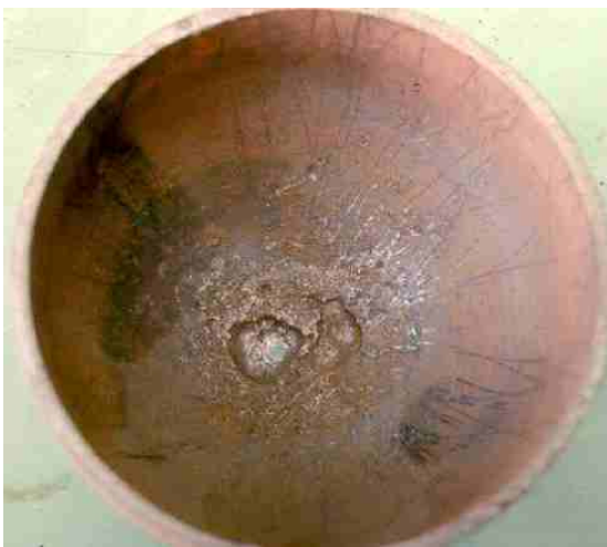
Lochfrass im Boden einer Taucherflasche
